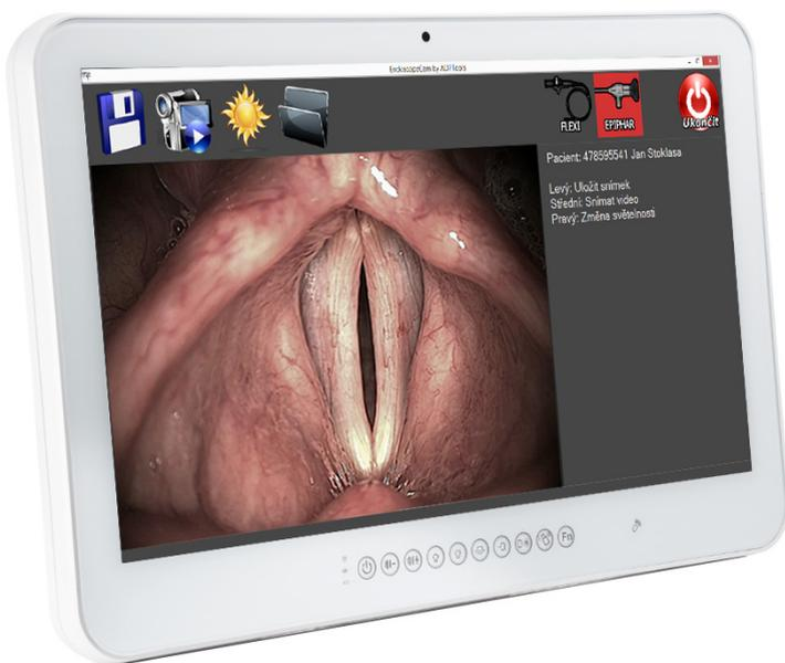
Es arbeitet mit unserer Kettex EVision-Software und der EndoPlay-Software zusammen, die es beispielsweise ermöglicht, Bilder/Videos zu speichern, den blauen Kontrast zu erhöhen, das Bild zu schärfen, das Bild zu entrauschen, das fibroskopische Gitter zu korrigieren und Bilder und Videos nebeneinander zu vergleichen.
